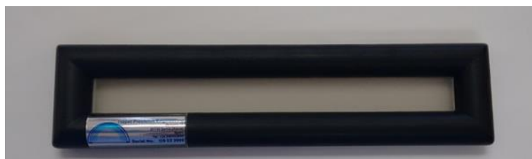
Ilustración 1. Regla óptica de trazos enmarcada de 200 mm
